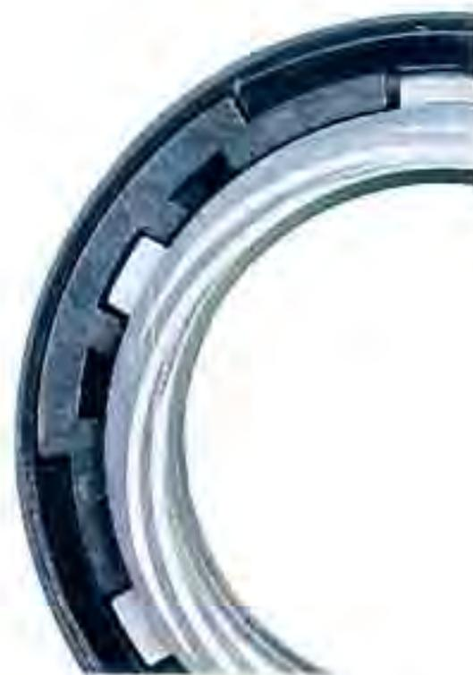
Activeseal™ 系统是获得专利的零泄漏双密封系统，可主动防止液体进入电机腔，因此可降低周长和定子出故障的风险。它由一个内密封件和一个外密封件组成，内密封件相当于一个微泵，外密封件可防止泵送介质漏入缓冲室。
