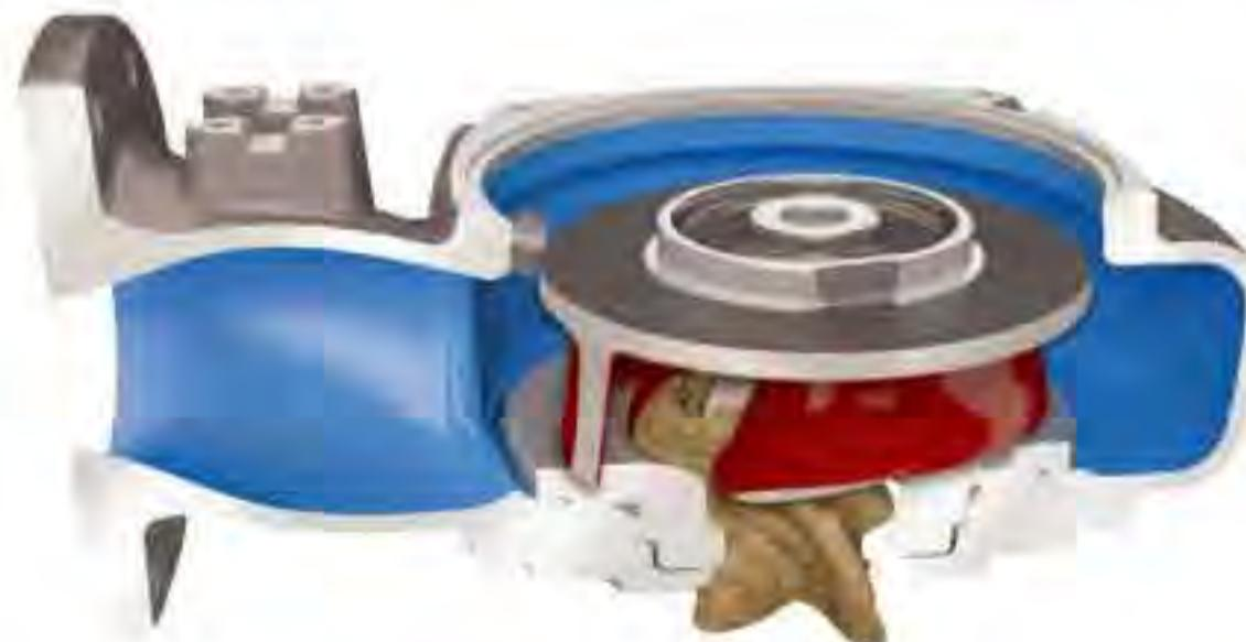
第1阶段：进入泵内的多数固体都会通过叶轮的叶片间隙。当固体被某一叶片的前缘刮住时，它会沿后扫式叶片朝进水口的周边滑动。
