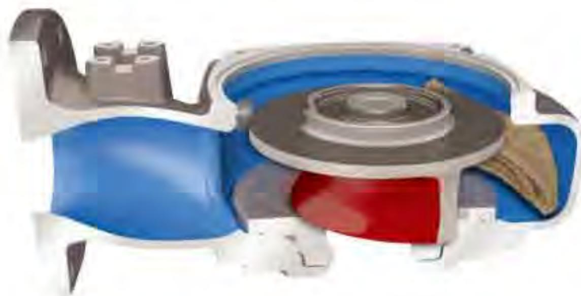
第2阶段：固体物质将通过叶片端部进入释放槽，插入环内的引导销将推动所有类型的固体物质离开叶轮中心，使之沿前缘移动并离开释放槽。
